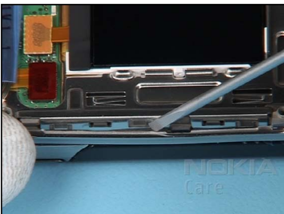
11. Lever up the B-COVER DECO.
